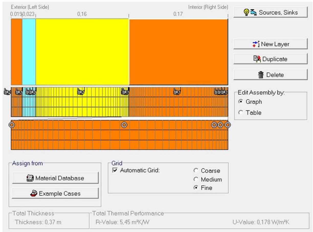
Figur 2 Oppbygning av standard Opplagt i WUFI.
